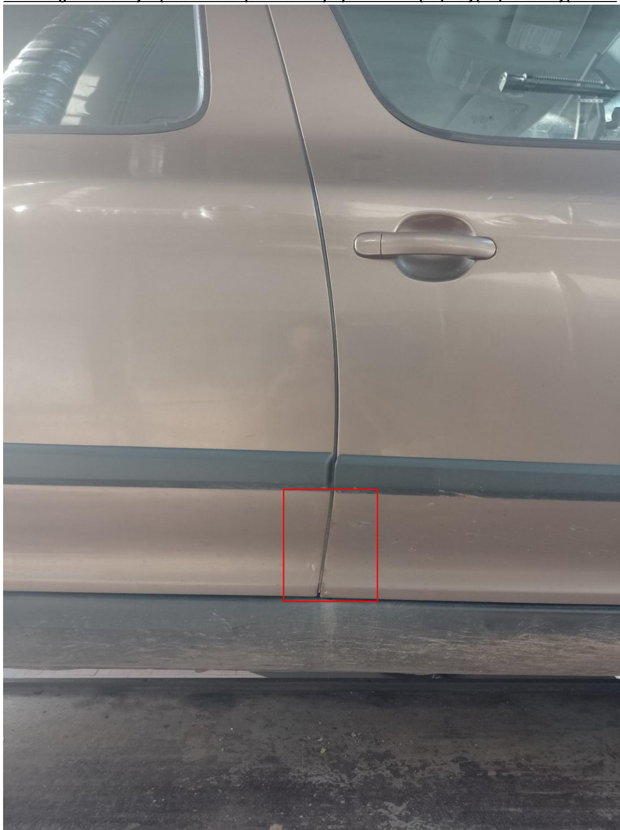
Trzecie ognisko korozji: łączenie drzwi przednich i tylnych dolna część (2 zdjęcia) . Zdjęcie nr 1
