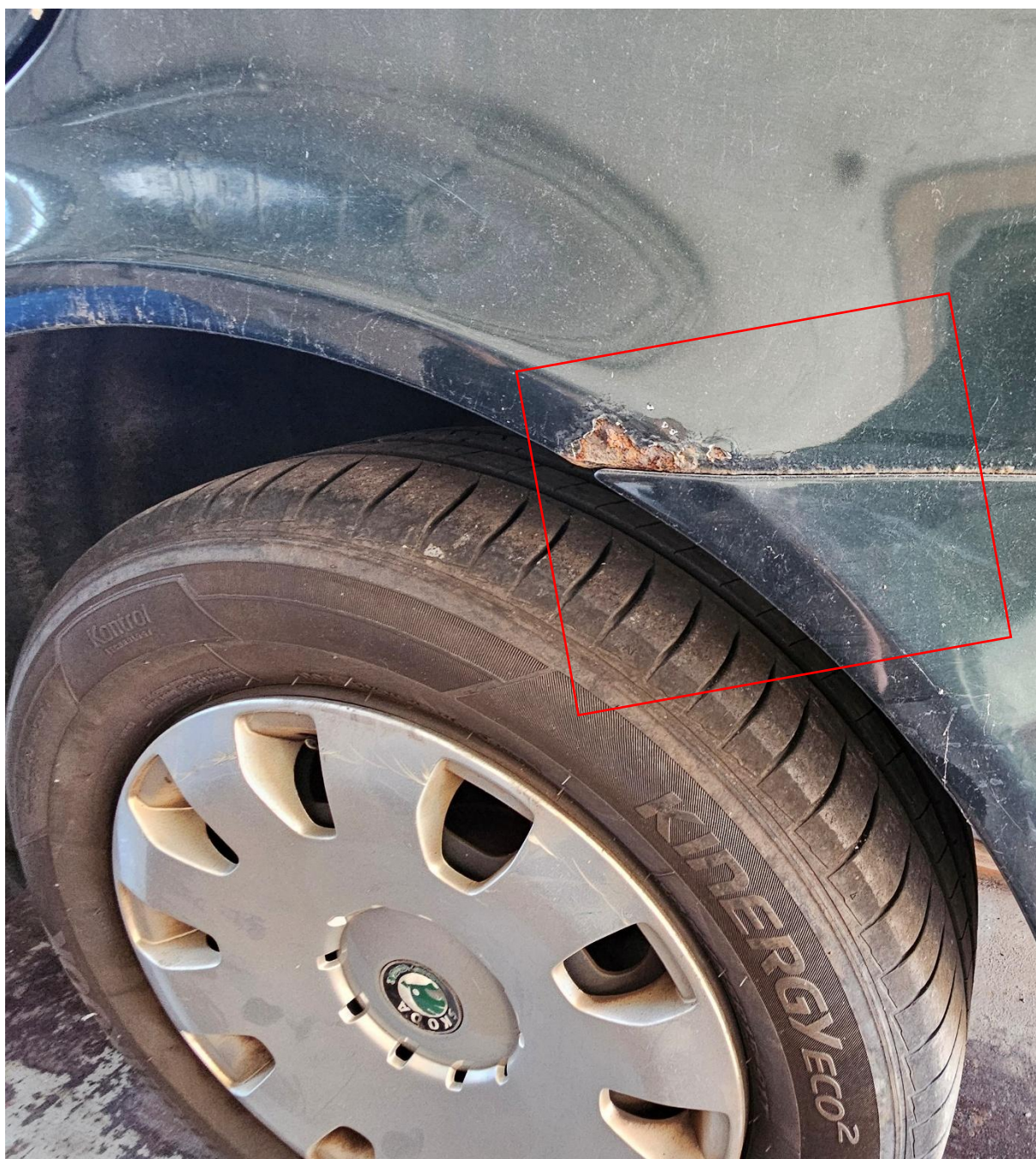
Szóste ognisko korozji: lewy tylny błotnik.
