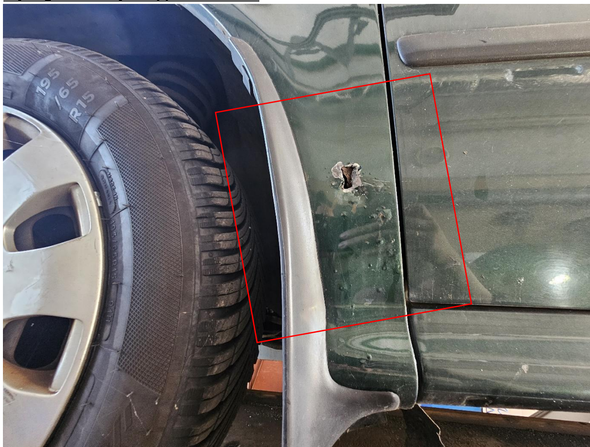
Piąte ognisko korozji: lewy przedni błotnik.
